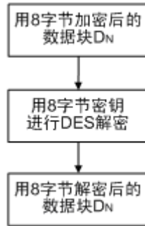
图 9-5 用长度为 8 字节的密钥进行数据加密的算法
